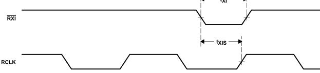
Figure 17. Read-Expansion-In Timing
