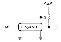
**B. AC TEST LOAD FOR 7.5 SPEED GRADE**
