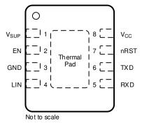
Figure 6-2. DRB Package, 8-Pin (VSON), Top View
