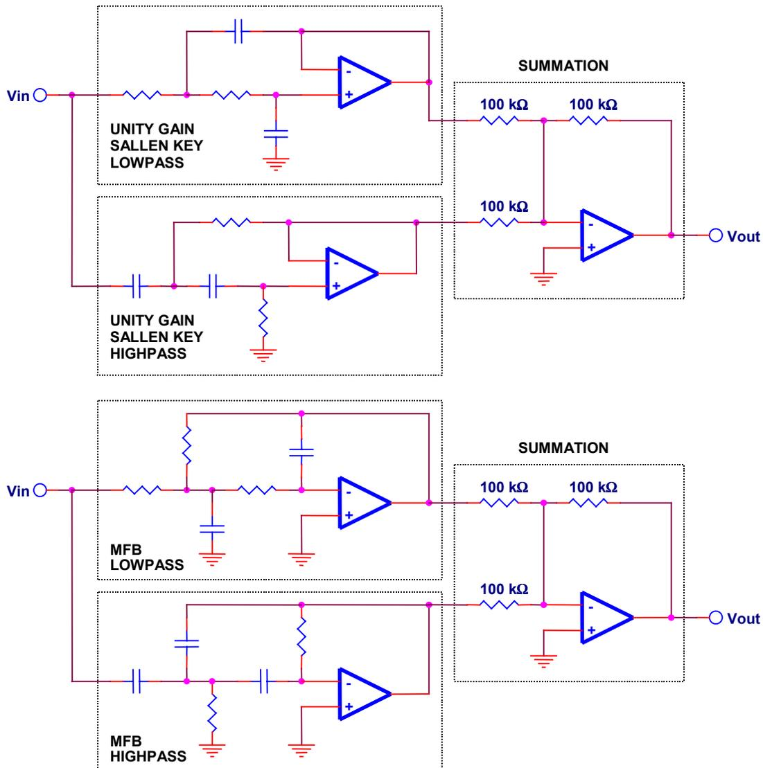
**Figure 22. Band Reject Filter Implementations**
