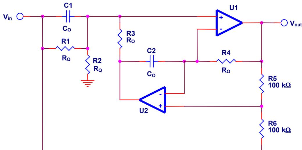
**Figure 21. Fliege Notch Filter**
