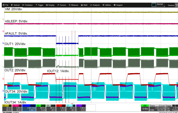
図 8-15. 過電流保護と回復
