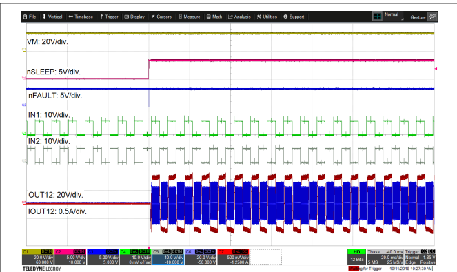
図 8-6. デバイスの電源投入、nSLEEP 使用
