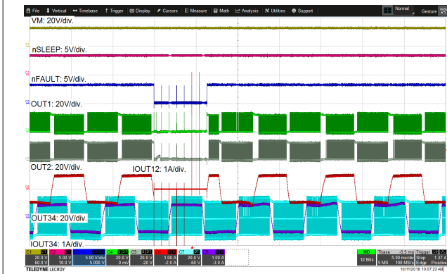
図 8-15. 過電流保護と回復
