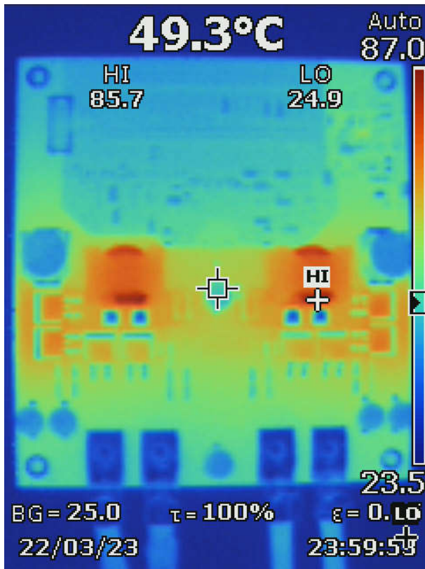
図 8-21. 熱画像 : 降圧モード、 V_{in} = 48V 、 V_{OUT} = 14.5V 、 I_{OUT} = 60A 、自然対流
