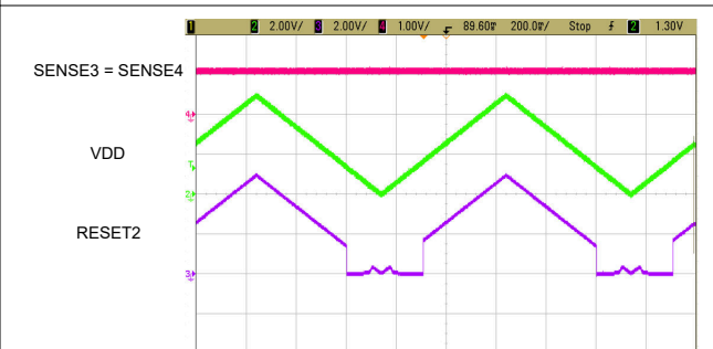
図 8-8. TPS37044 過電圧および低電圧機能
