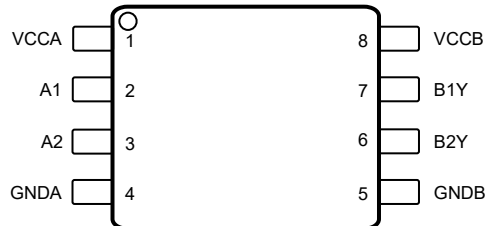
図 4-4. TXGx020DDF 8 ピン SOT および TXGx020D 8 ピン SOIC (上面図)
