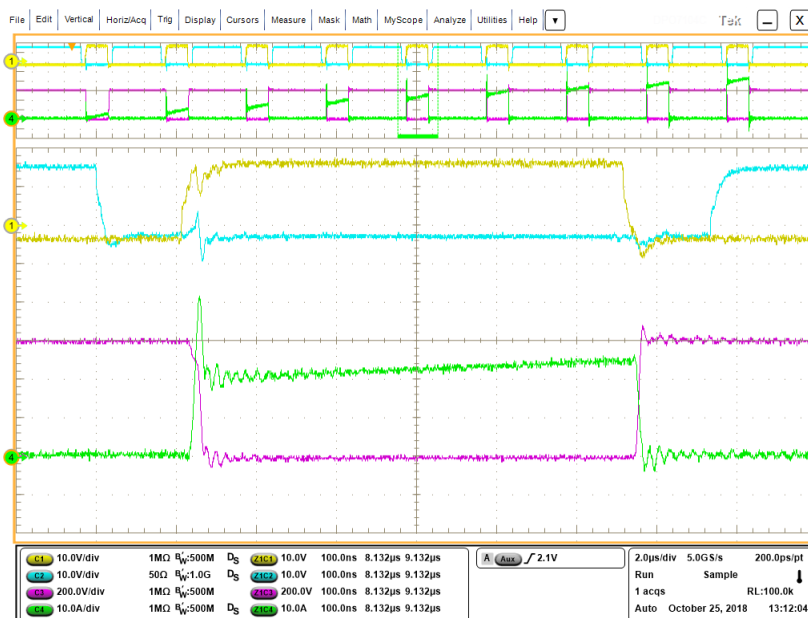
図 8-6. SiC MOSFET のスイッチング波形
