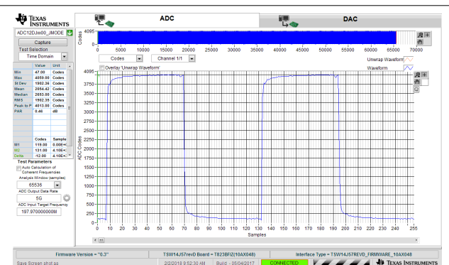
図 8-7. 5GSPS シングル チャネル オシロスコープにおける 40MHz、方形波時間ドメイン
