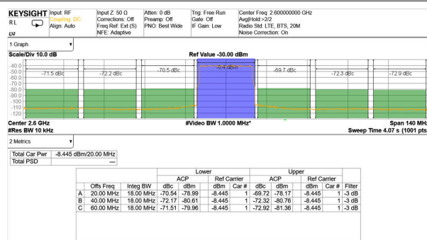
図 4-408. TX 20MHz LTE 出力スペクトル (バンド 41、2.6GHz)
