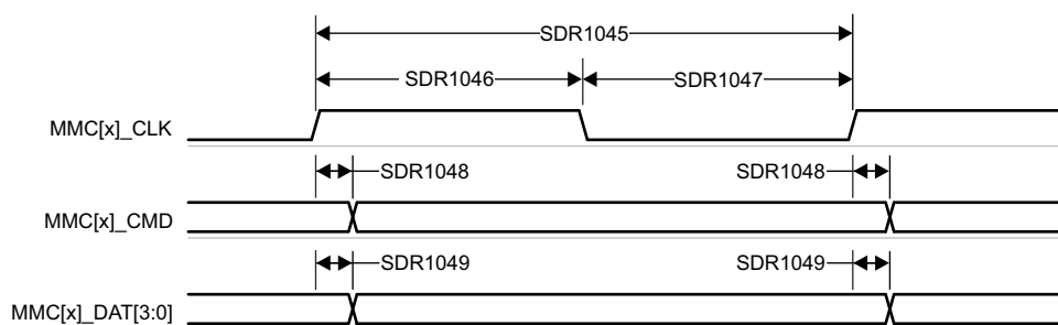
図 6-76. MMC1 – UHS-I SDR104 – 送信モード
