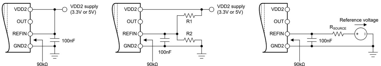
図 8-3. REFIN ピンに接続します
