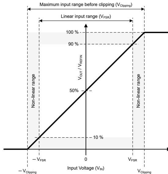
図 7-2. AMC0x30R の入力から出力への伝達曲線
