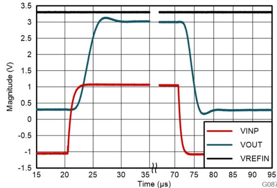
図 8-4. AMC0x30R のステップ応答
