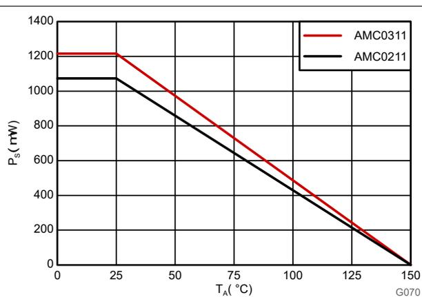
図 6-3. VDE に従う安全性制限電力の熱特性低下曲線
