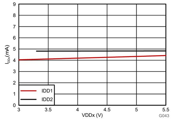
図 6-13. 電源電流と電源電圧との関係
