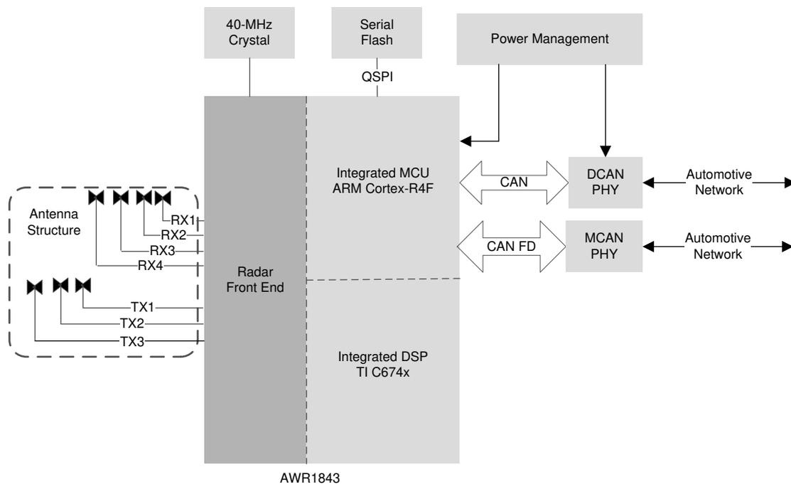
図 10-1. 短距離および中距離レーダー
