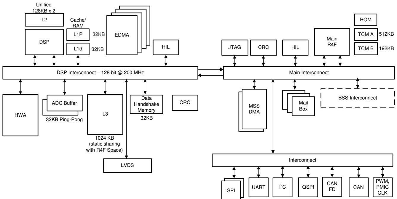
図 8-5. プロセッサ サブシステム
