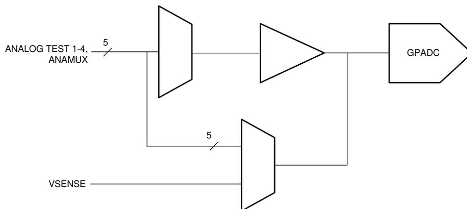
A. GPADC 構造は、内部温度センサの出力を測定するために使われます。これらの測定の精度は、 $\pm 7^{\circ}\text{C}$ です。
