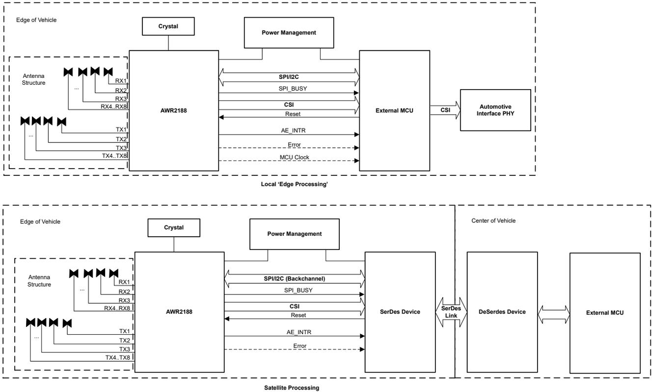
図 2-1. 車載アプリケーション用のレーダー センサ
