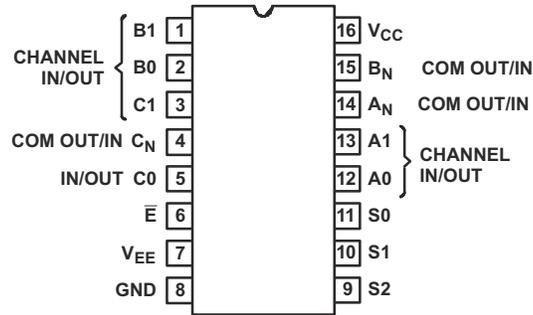
図 4-3. CDx4HCx4053 J、N、D、NS、PW パッケージ 16 ピン CDIP、PDIP、SOIC、SO、TSSOP (上面図)
