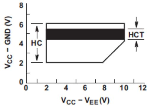
図 5-2. ( $V_{CC} - GND$ ) に応じた推奨動作領域
