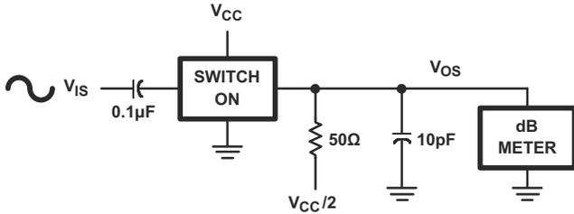
図 6-2. 周波数応答テスト回路
