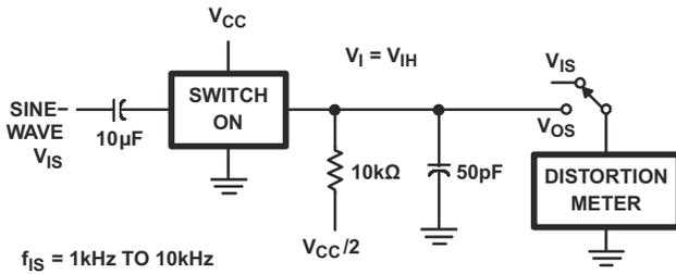
図 6-4. 1/4 正弦波歪みテスト回路
