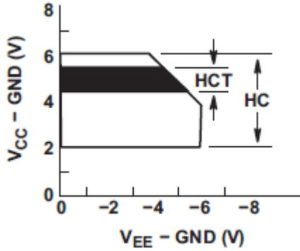
図 5-1. ( $V_{CC} - V_{EE}$ ) に応じた推奨動作領域
