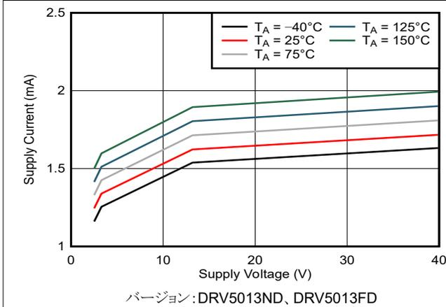
図 5-3.  $I_{CC}$  と  $V_{CC}$  との関係
