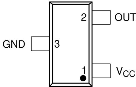
図 4-1. DBZ パッケージ 3 ピン SOT-23 上面図
