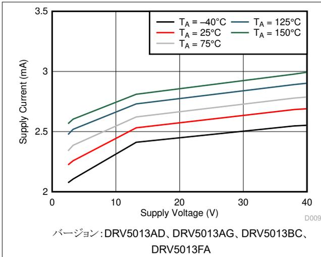
図 5-1.  $I_{CC}$  と  $V_{CC}$  との関係
