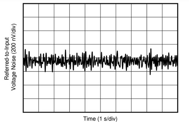
図 6-30. 0.1Hz~10Hz の電圧ノイズ (入力換算)
