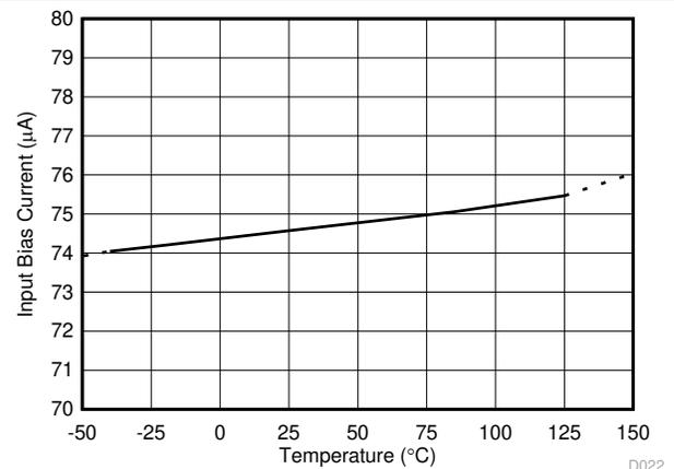
図 6-22. 入力バイアス電流と温度との関係
