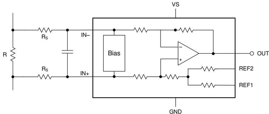
図 9-1. 入力ピンに配置したフィルタ
