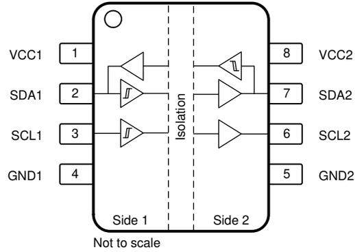
**图 5-2. ISO1541 D Package 8-Pin SOIC Top View**
