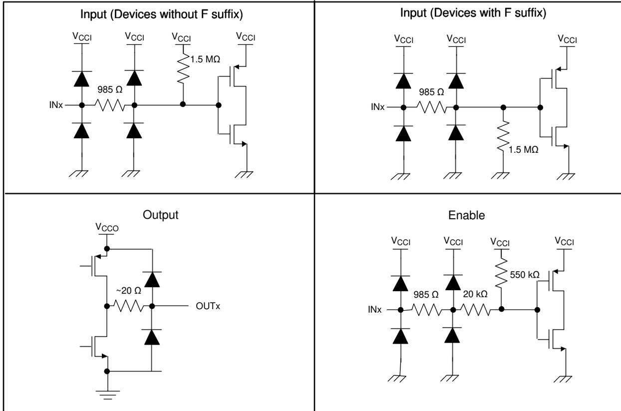
図 7-3. デバイス I/O 回路図
