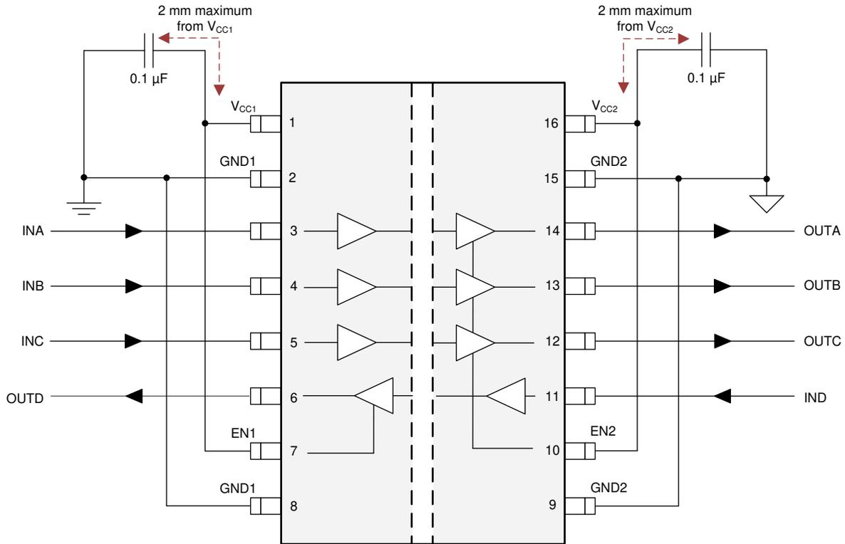
**図 8-2. ISO674x-Q1 回路の標準的な接続**
