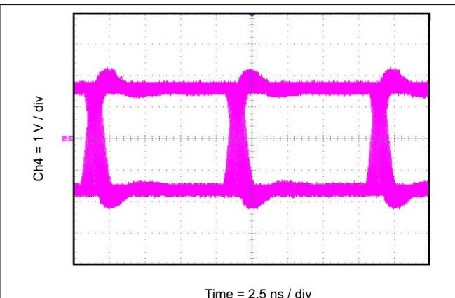
図 8-4. 100Mbps の PRBS 2<sup>16</sup> - 1、3.3V、25°Cのアイ・ダイアグラム
