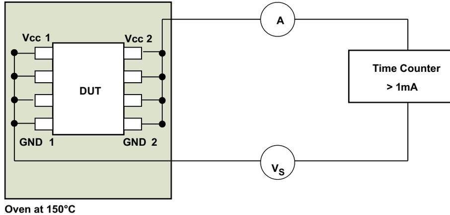
図 8-6. 絶縁寿命測定用のテスト構成
