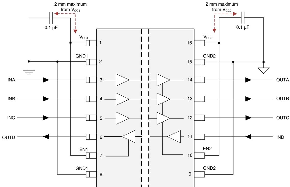
**図 8-2. ISO774x-Q1 回路の標準的な接続**
