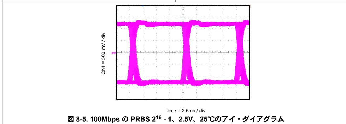
図 8-5. 100Mbps の PRBS 2<sup>16</sup> - 1、2.5V、25°Cのアイ・ダイアグラム
