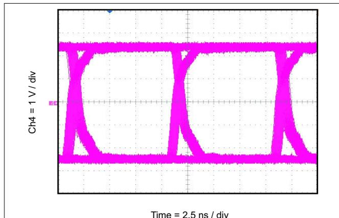
図 8-3. 100Mbps の PRBS 2<sup>16</sup> - 1、5V、25°Cのアイ・ダイアグラム
