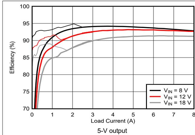
图 9-6. Efficiency vs I<sub>OUT</sub>
