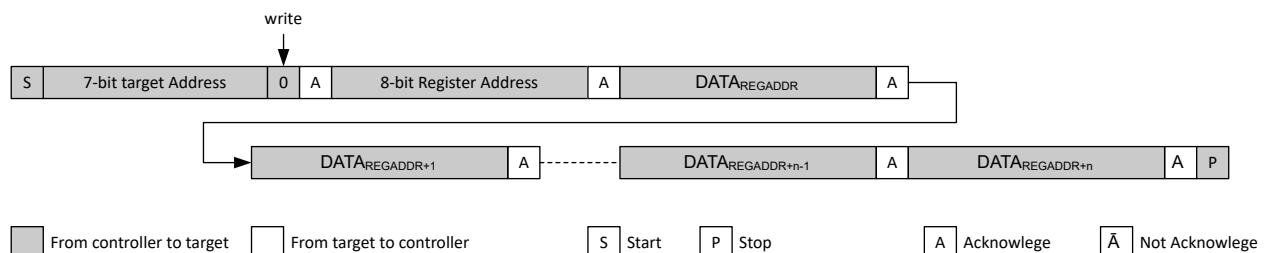
図 7-42. 定義されたレジスタ アドレスから開始されるシーケンシャル WRITE
