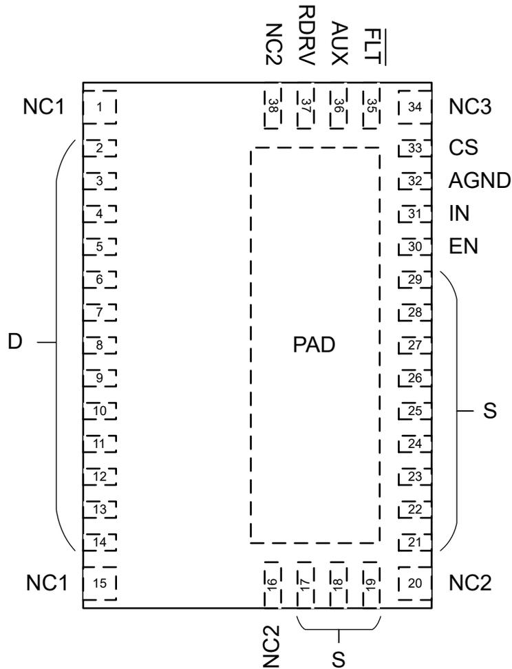
図 4-1. REQ パッケージ、38 ピン VQFN (上面図)
