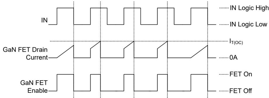
図 7-5. サイクル単位の過電流保護動作
