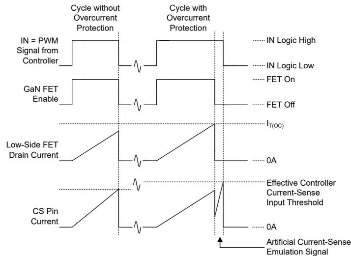
図 7-3. 電流検出エミュレーションの動作
