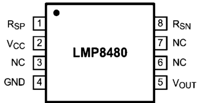
図 5-1. LMP8480 VSSOP パッケージ、8 ピン (上面図)
