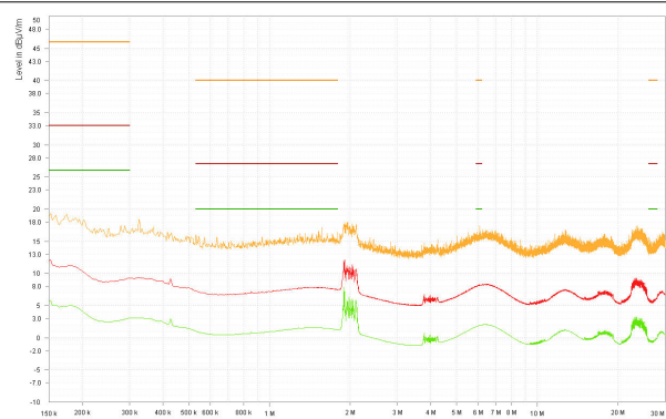
V_{OUT} = 3.3V F_{SW} = 2MHz I_{OUT} = 1A 周波数スパン: 150kHz ~ 30MHz
