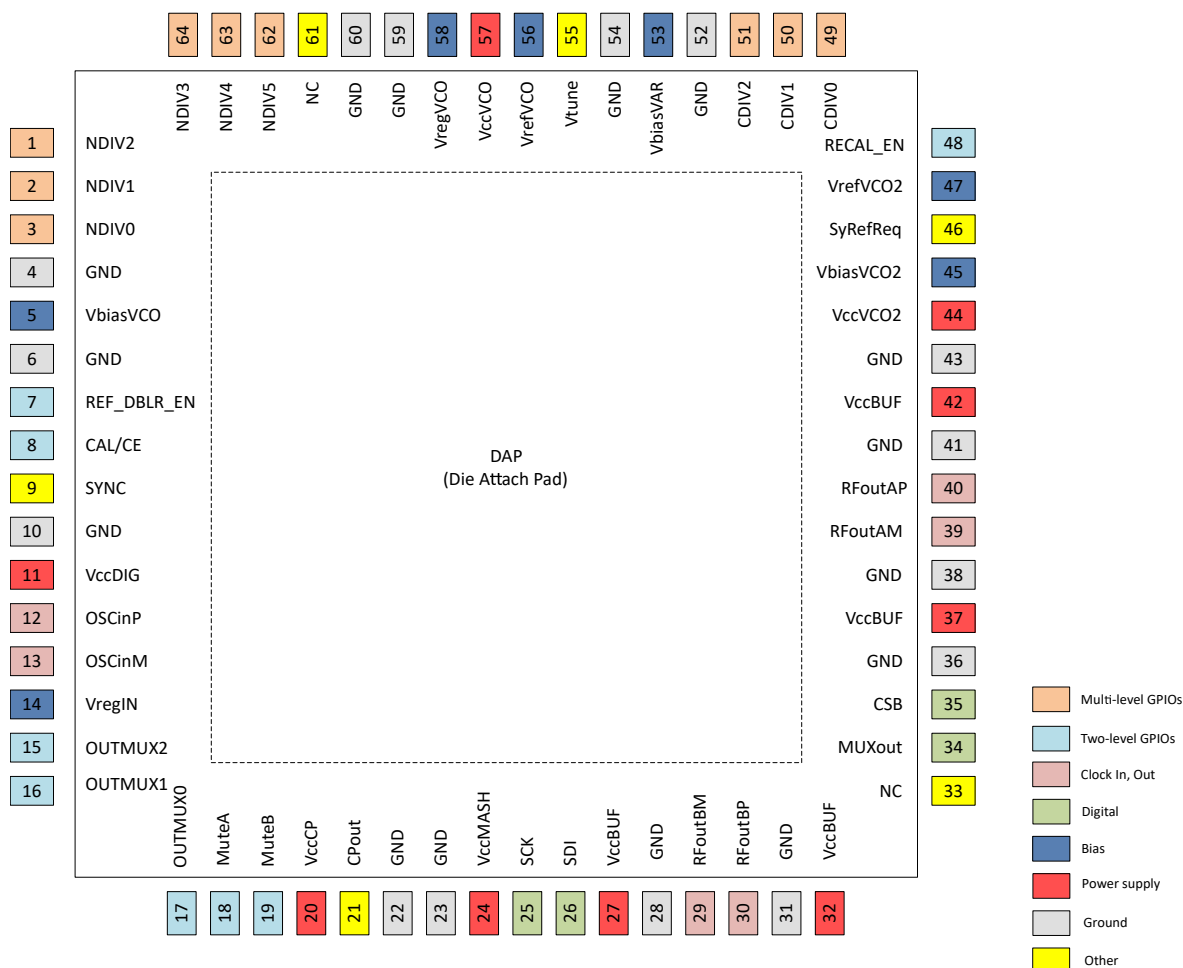
図 4-1. HBD パッケージ 64 ピン CQFP 上面図
