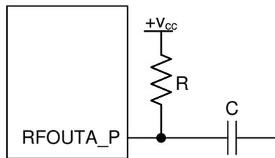
图 8-2. Resistor Pullup
