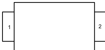
図 4-1. DYP パッケージ、2 ピン SMAF (上面図)
