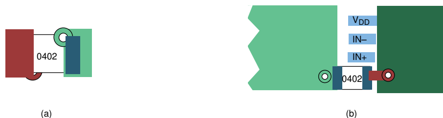
図 11-7. デカップリング コンデンサの標準レイアウト
