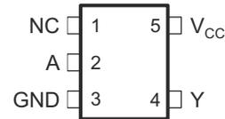
図 4-2. DRL パッケージ 5 ピン SOT-5X3 上面図
