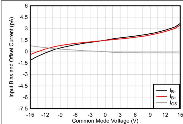
図 4-1. 入力バイアス電流と同相入力電圧との関係
