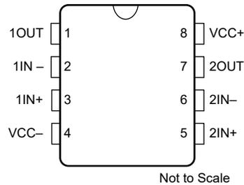
図 3-2. TL052 D、P、または PS パッケージ、8 ピン SOIC、PDIP、または SOP (上面図)
