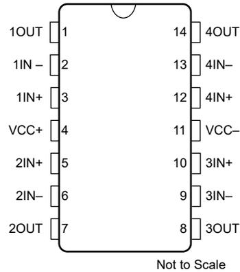
図 3-3. TL054 D、DB、N、または NS パッケージ、14 ピン SOIC、SSOP、PDIP、または SOP (上面図)
