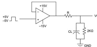
図 5-2. 出力特性のテスト回路
