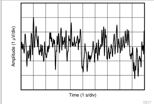
図 7-17. 0.1Hz~10Hz の統合電圧ノイズ
