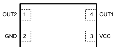
図 5-2. ZFC パッケージ、4 ピン X1LGA (上面図)
