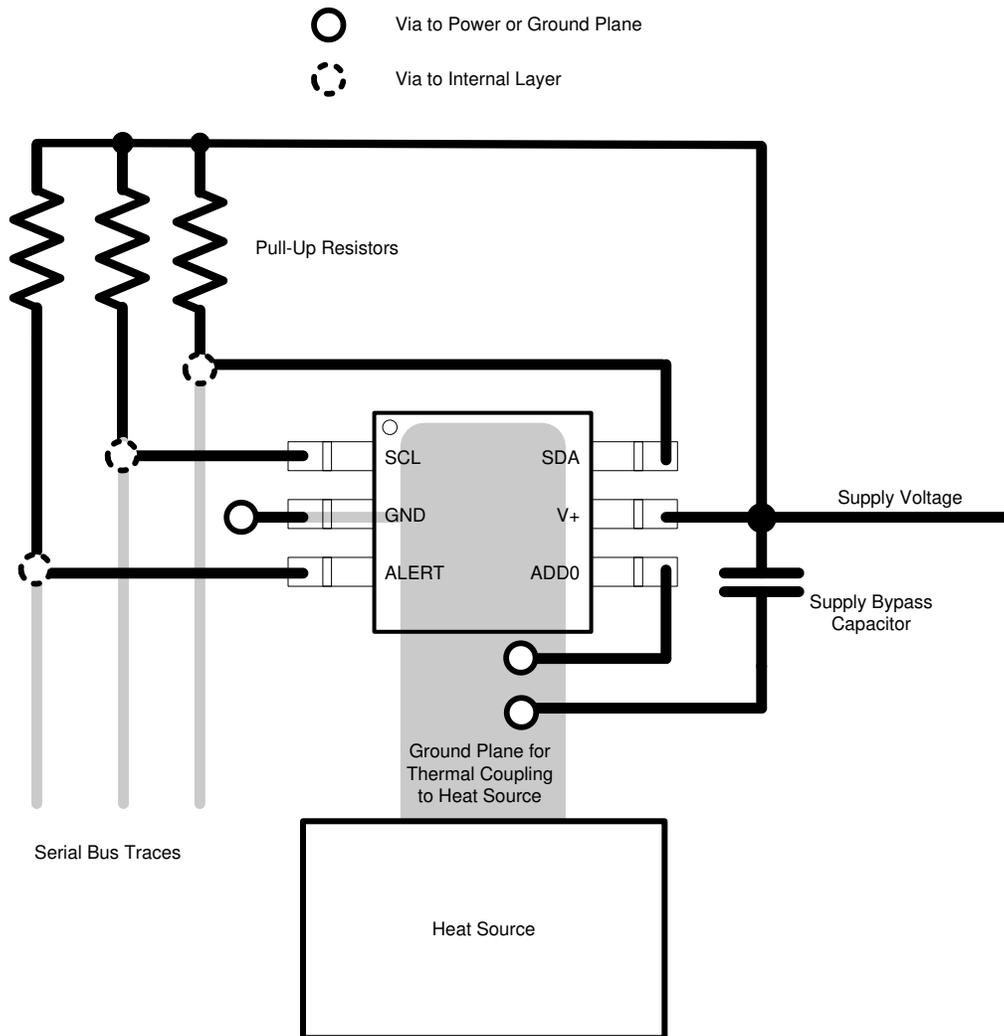
図 8-5. レイアウト例 (SOT563-6 パッケージ)
