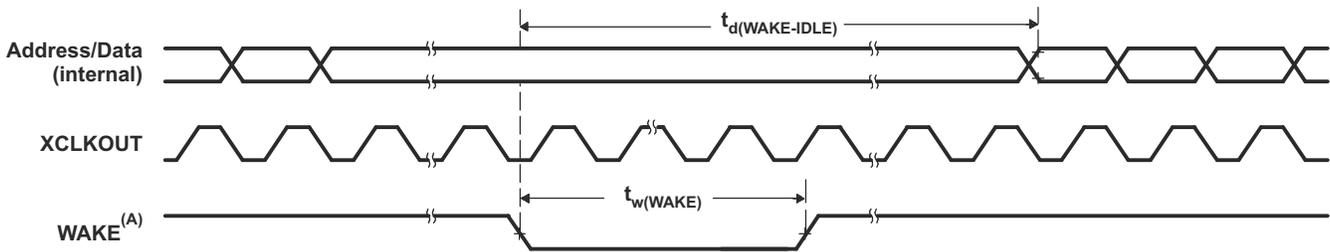
A. WAKE には、イネーブルになっている任意の割り込み、 $\overline{WDINT}$ 、 $XRSn$  を使用できます。IDLE 命令が実行された後、ウェークアップ信号がアサートされる前に、5 OSCCLK サイクル (最小値) の遅延が必要です。
