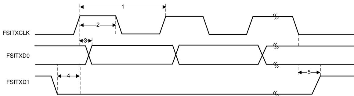
図 6-99. FSITX SPI 信号モードのタイミング
