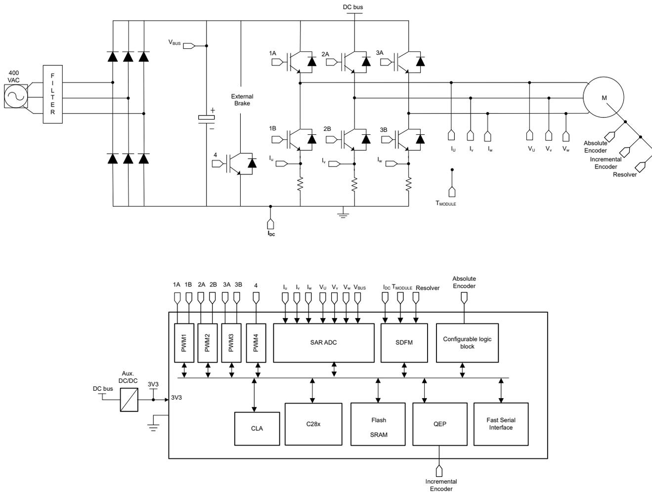
図 8-7. サーボ ドライブ制御モジュール
