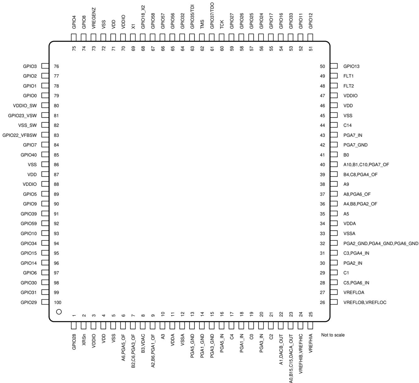
A. GPIO 端子には GPIO 機能のみを表示しています。多重化された信号名全体については、セクション 5.3 を参照してください。
