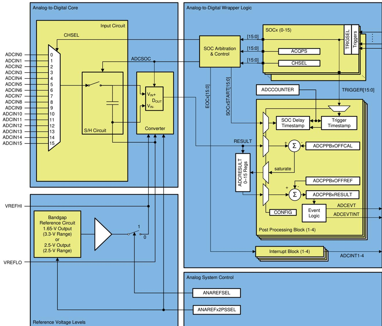
図 6-41. ADC モジュールのブロック図
