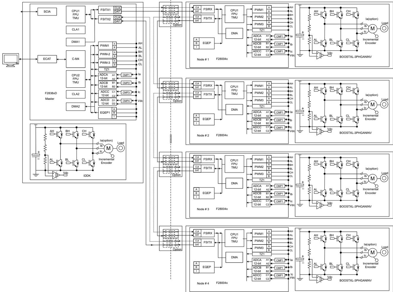
図 8-8. 分散型多軸サーボドライブ
