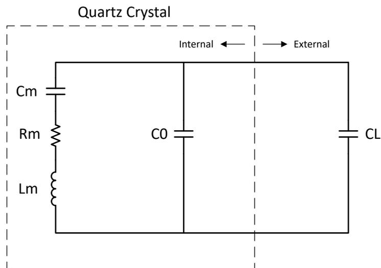
図 6-21. 水晶振動子の電氣的表現
