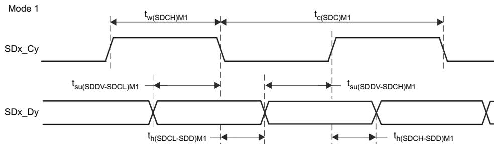
図 6-75. SDFM タイミング図 – モード 1
