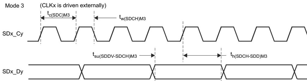
図 6-77. SDFM タイミング図 – モード 3
