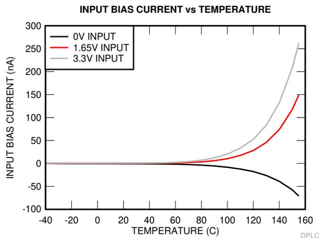
図 6-46. 入力バイアス電流と温度との関係
