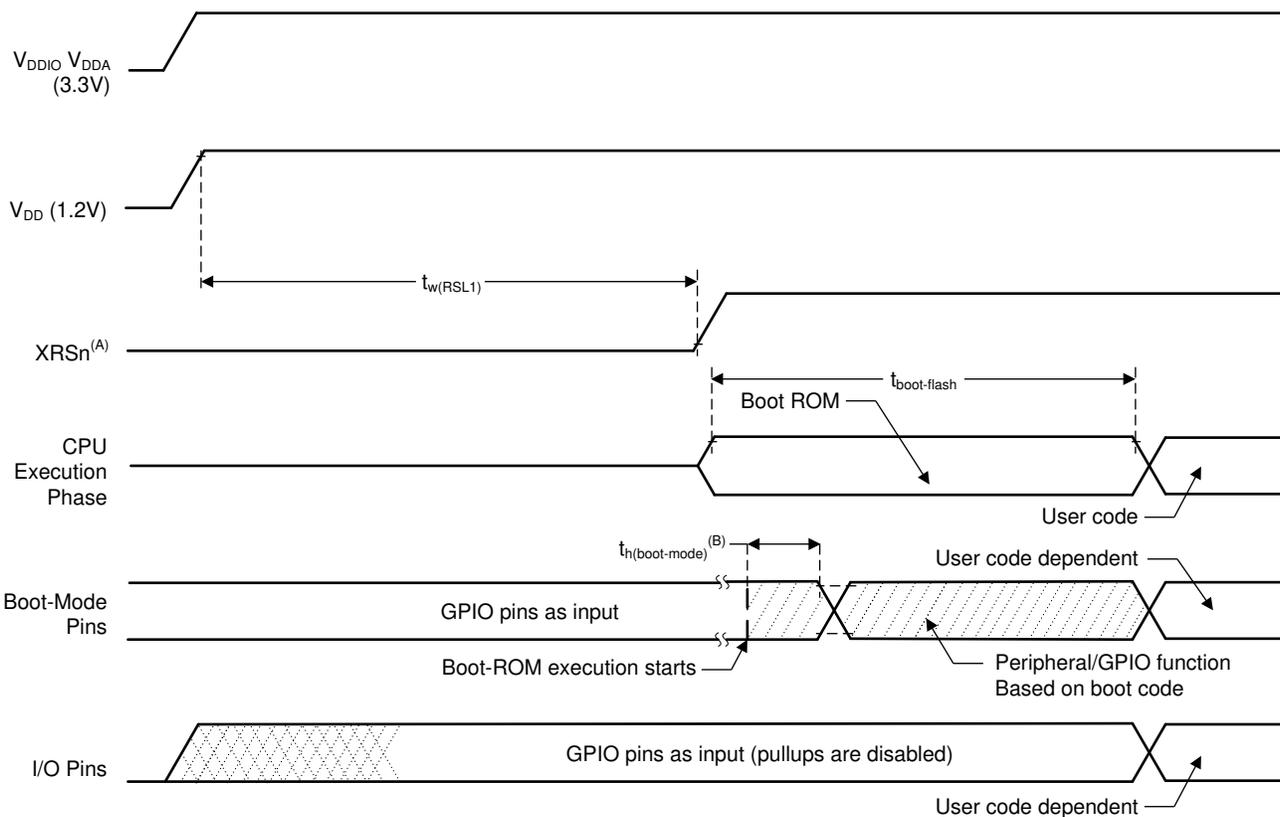
A. XRSn ピンは、スーパーバイザまたは外部プルアップ抵抗によって外部から駆動できます。「ピン属性」を参照してください。オンチップ POR ロジックは、電源が有効範囲になるまでこのピンを LOW に保持します。
