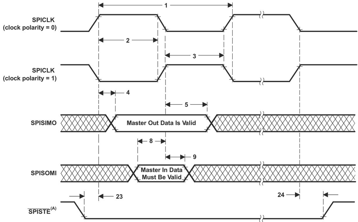
A. ワードの末尾では、FIFO モードおよび非 FIFO モードの連続送信ワード間を除いて、 $\overline{\text{SPISTE}}$  は、非アクティブになります。
