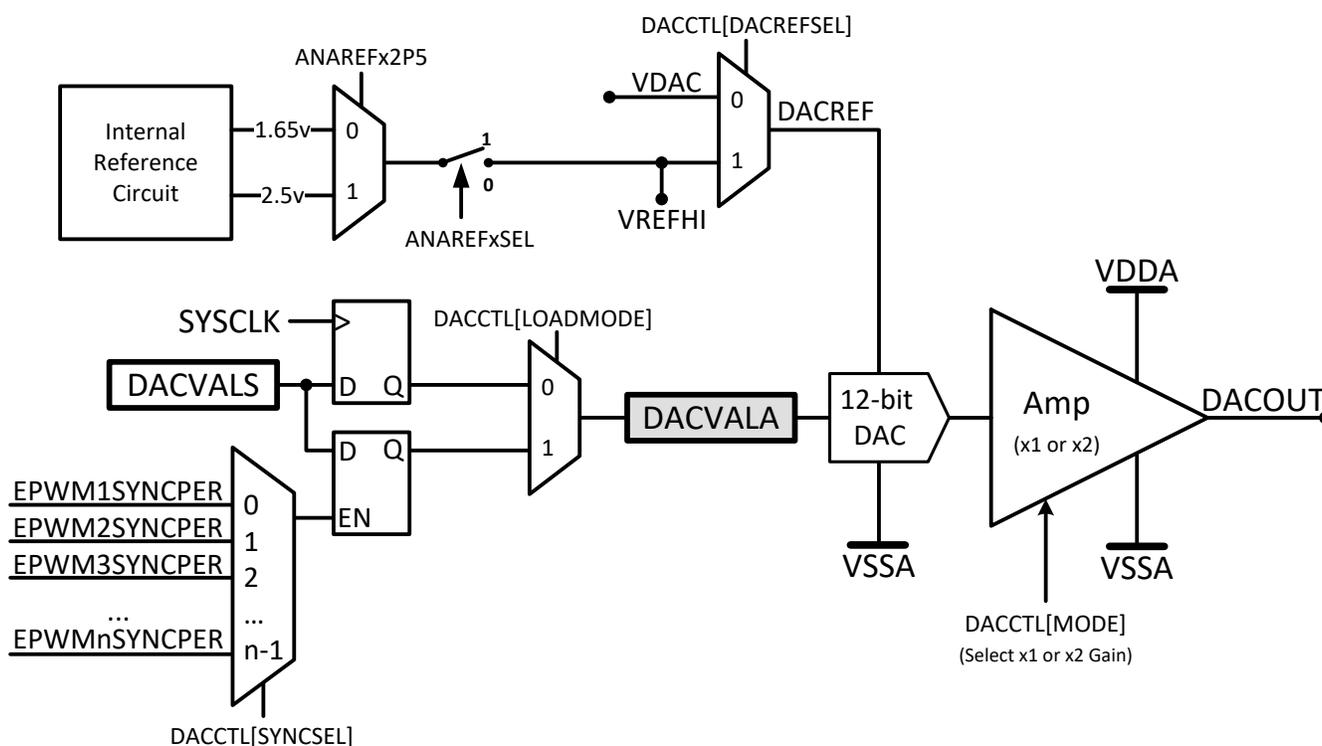
図 6-47. DAC モジュールのブロック図
