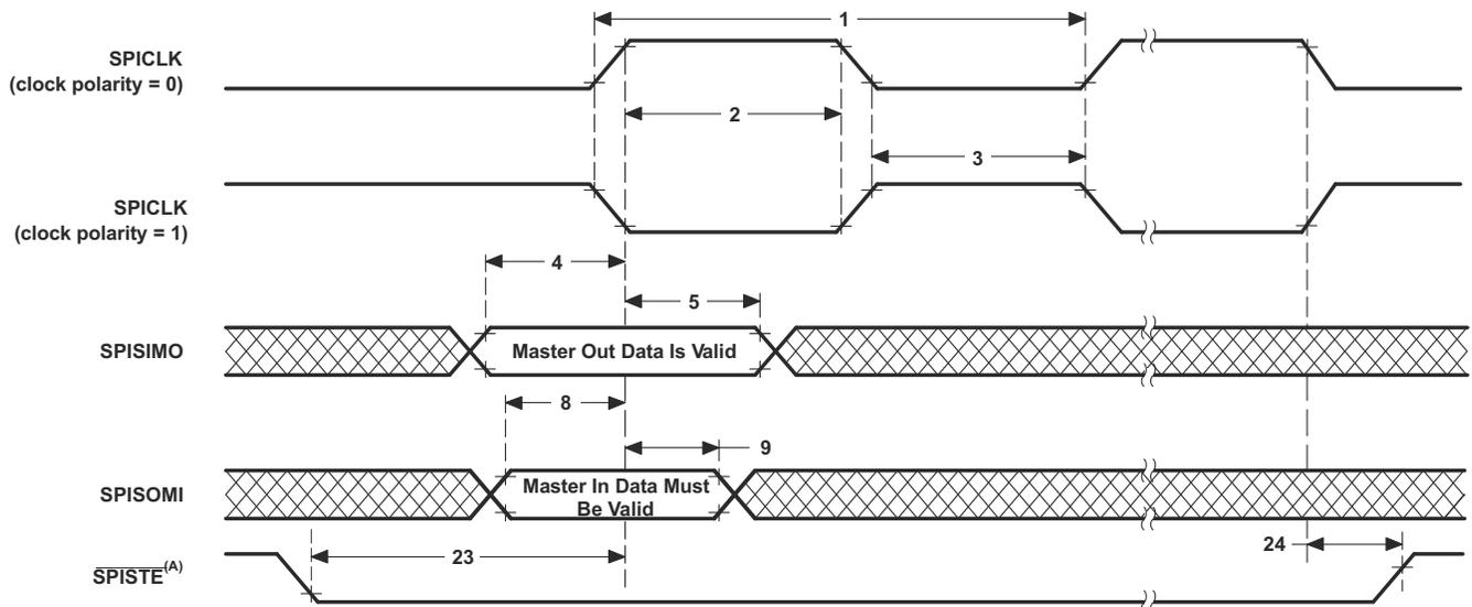
A. ワードの末尾では、FIFO モードおよび非 FIFO モードの連続送信ワード間を除いて、 $\overline{\text{SPISTE}}$  は、非アクティブになります。
