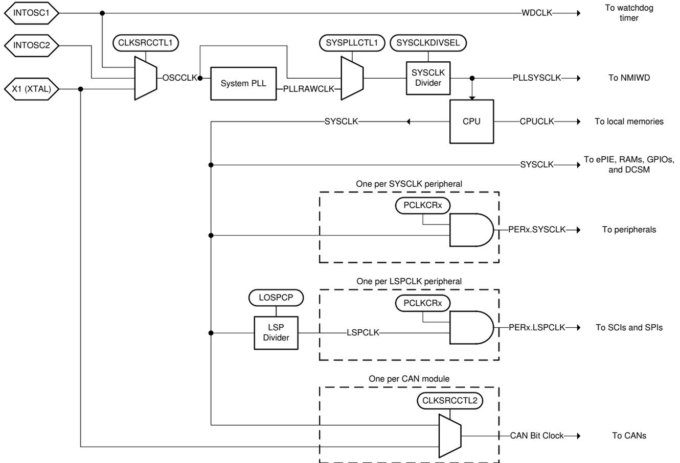
図 6-15. クロック供給システム
