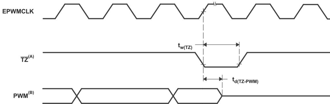
A.  $\overline{\text{TZ}}$ :  $\overline{\text{TZ1}}$ ,  $\overline{\text{TZ2}}$ ,  $\overline{\text{TZ3}}$ , TRIP1~TRIP12
