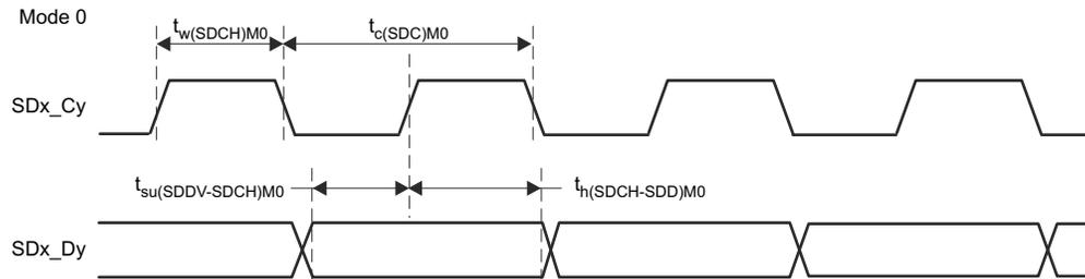
図 6-74. SDFM タイミング図 – モード 0
