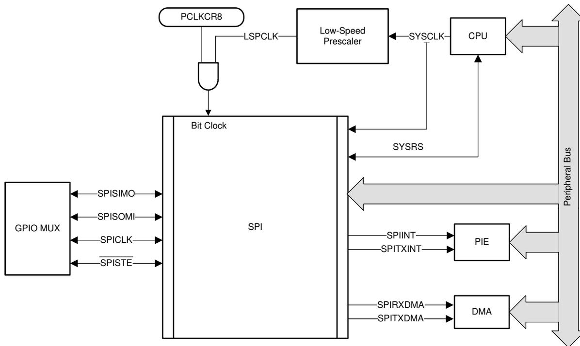
図 6-83. SPI CPU インターフェイス
