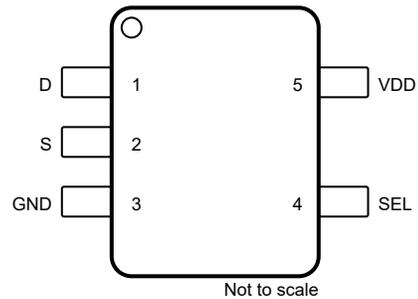
図 5-2. DBV Package 5-Pin SOT-23 (Top View)
