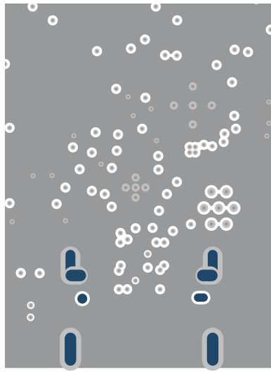
図 7-6. TPS26750 PCB Layout - GND Layer 2
