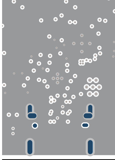
図 7-9. TPS26750 PCB Layout - GND Layer 5
