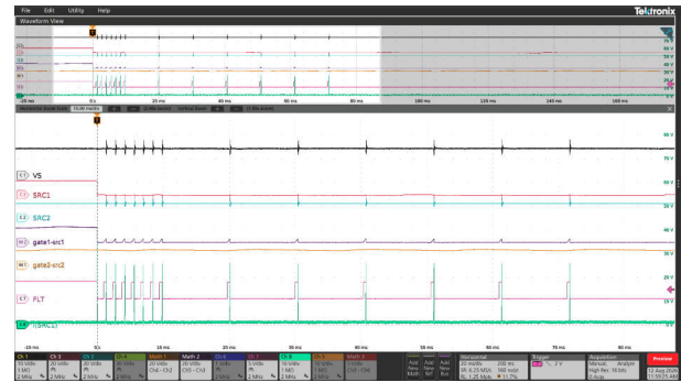
図 9-12. RSNS = 1\text{m}\Omega 、SCP スレッシュホールド = 20\text{mV} 、 SCP 遅延 = 1.1\mu\text{s} 、自動再試行時間 = 1\text{ms} 、 FOLDBACK_LOCK_DIS = 0x0 (有限自動再試行サイ クル) でのアクティブモードにおける CH1 の出力グ ランド短絡故障動作の拡大図
