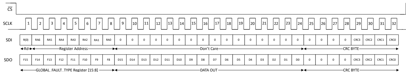
図 7-29. 32 ビット読み取り、CRC イネーブル (CRC_EN = 1)
