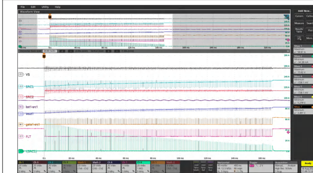
図 9-7. C_{OUT} = 3.3\text{mF} 、 C_{BST} = 2\mu\text{F} 、 LIN = 2\mu\text{H} 、 LOUT = 1\mu\text{H} 、SCP スレッショルド = 10mV、SCP 遅延 = 5.2 \mu\text{s} 、自動再試行時間 = 1ms、 FOLDBACK\_LATCH\_DIS = 0x1 (無限自動再試行サイクル)、 CAP\_CHRG\_CHx = 0x0 (SCP ベースの自動再試行) で CHx\_ON ビットを '0' から '1' に設定
