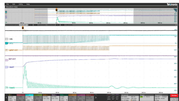
図 9-6. C_{OUT} = 3.3\text{mF} 、 C_{GATE} = 100\text{nF} 、 C_{BST} = 2\mu\text{F} 、 LIN = 5\mu\text{H} 、 LOUT = 1\text{mH} 、PWM 周波数 = 885Hz、 CAP\_CHRG\_CHx = 0x3 (PWM 方式) で CHx\_ON ビットを '0' から '1' に設定
