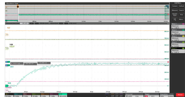
図 8-10. 150pF の C_{SNS} ありの場合の SNS ピン リップル、 V_{BB} = 13.5V 、 I_{LIM} = 開放、 R_L = 10\Omega 、 R_{SNS} = 1k\Omega 、 T_A = 25^\circ C にて
