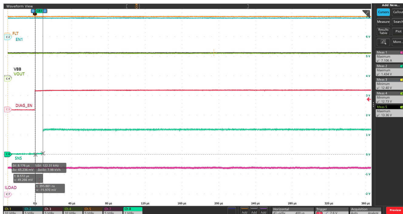
図 8-5. DIAG_EN による SNS 応答時間 ( t_{\text{SNSION1}} )
