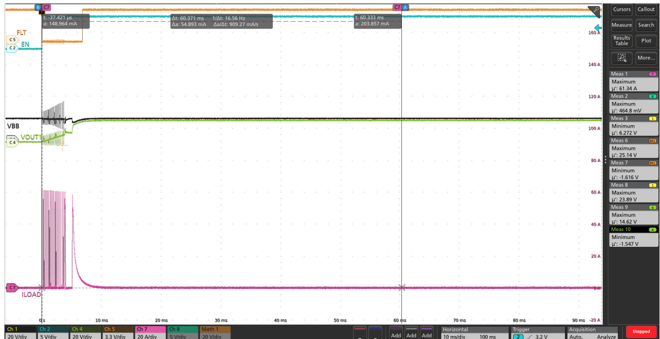
図 8-29. VBB = 13.5V、ILIM ピンをグランドに短絡し、周囲温度 125°C の条件で TPS1HC03-Q1 デバイスを用いた 680 \mu F の容量性負荷充電
