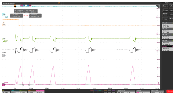
図 9-9. デバイスの開放負荷故障発生時の開放負荷検出遅延 (t OL2 ) (P、D バージョン)
