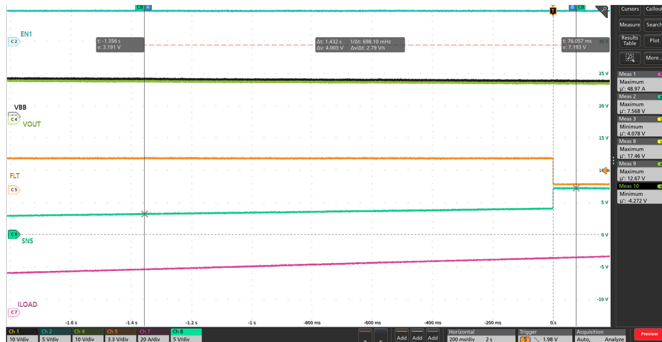
図 8-4. 負荷電流変化時の SNS ピン電圧 ( R_{SNS} = 1k\Omega )
