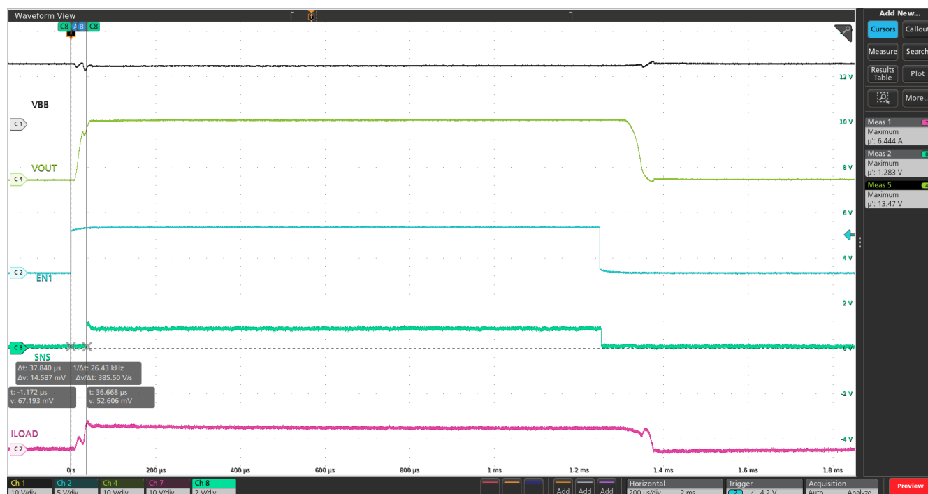
図 8-6. EN による SNS 応答時間 ( t_{\text{SNSION3}} )
