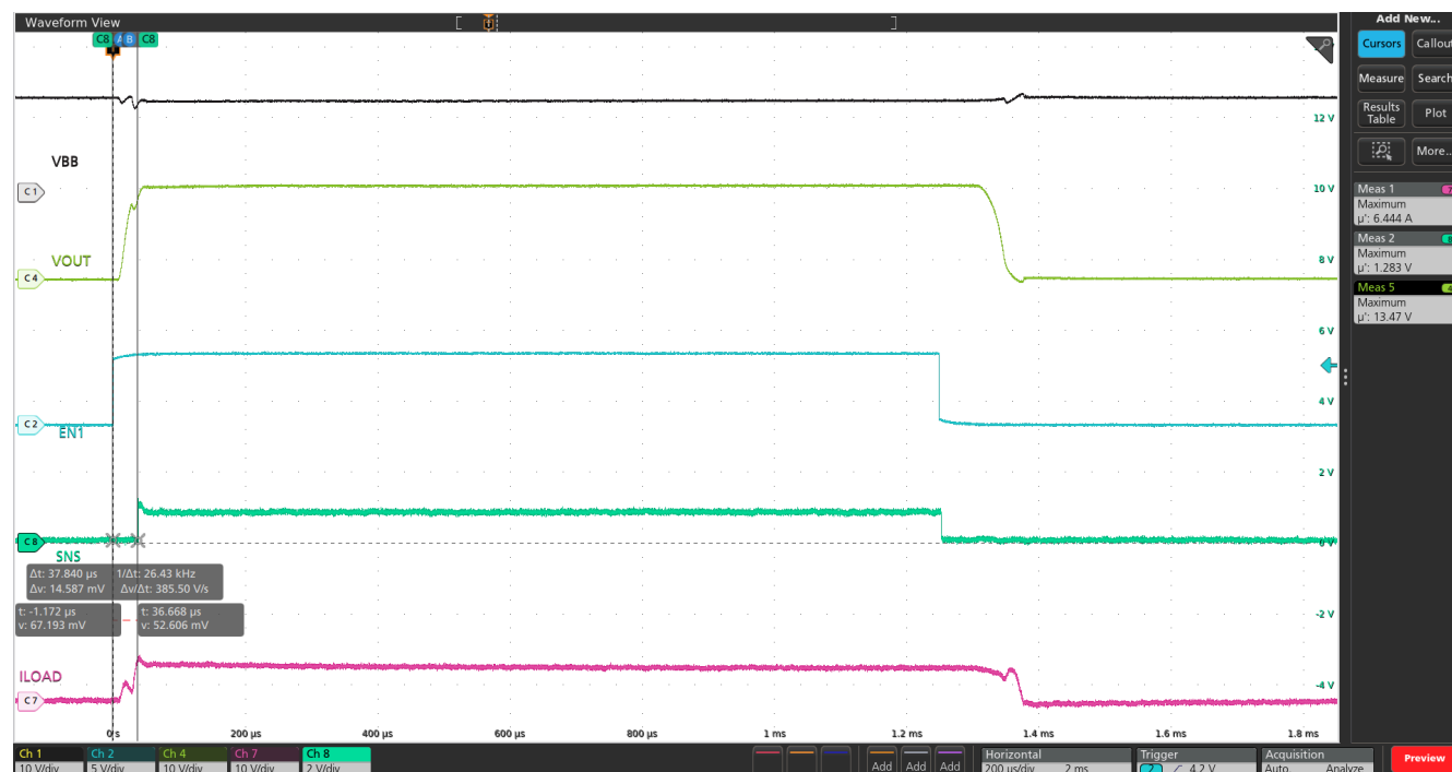
図 8-6. EN による SNS 応答時間 ( t_{SNSION3} )
