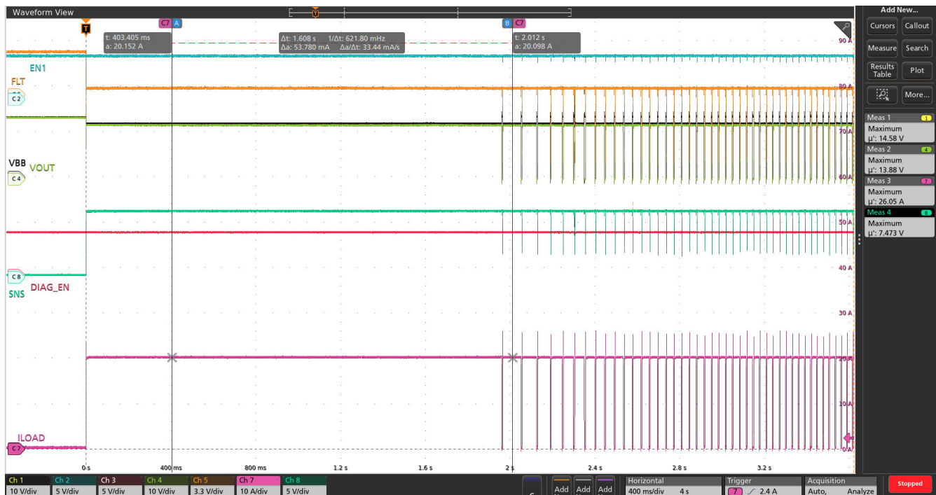
図 8-18. デバイスは電流制限 ( I_{\text{LIM}}=\text{GND} ) 未満の負荷電流 (20A 電子負荷) における無限サーマルシャットダウンの再試行動作を開始します
