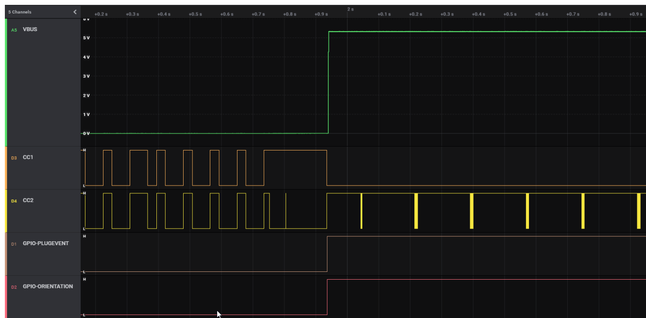
図 9-14. USB SuperSpeed マルチプレクサ制御 - 反転方向
