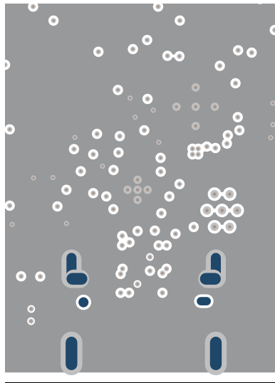
図 8-31. TPS26750 PCB Layout - GND Layer 5
