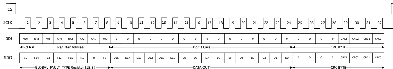
図 8-27. 32 ビット読み取り、CRC イネーブル (CRC_EN = 1)
