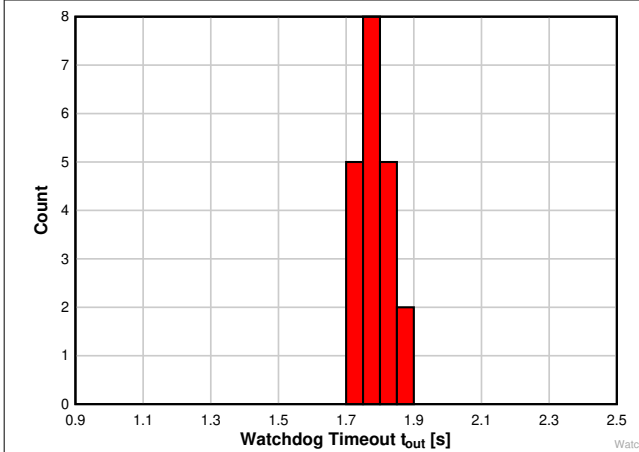
図 6-14. 125°Cでの TPS3823A-33 デバイスのウォッチドッグ・タイムアウト・ヒストグラム (ユニット数 = 20)
