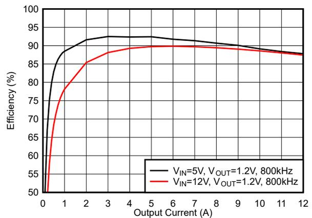
図 5-12. 効率 : FCCM モード、 $f_{sw} = 800kHz$
