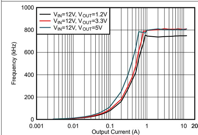
図 5-33.  $F_{SW}$  負荷レギュレーション : モード = DCM、 $F_{SW}$  = 800kHz
