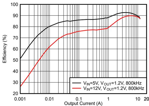
図 5-11. 効率 : DCM モード、 $f_{sw} = 800kHz$
