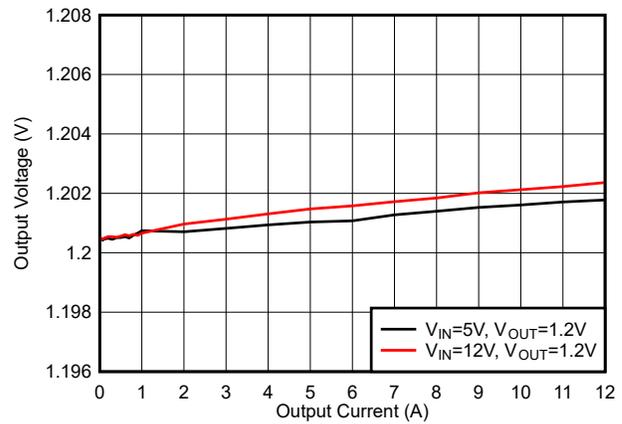
図 5-22. 負荷レギュレーション :  $f_{sw} = 800\text{kHz}$
