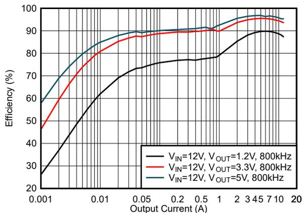
図 5-17. 効率 : DCM モード、 $f_{sw} = 800\text{kHz}$
