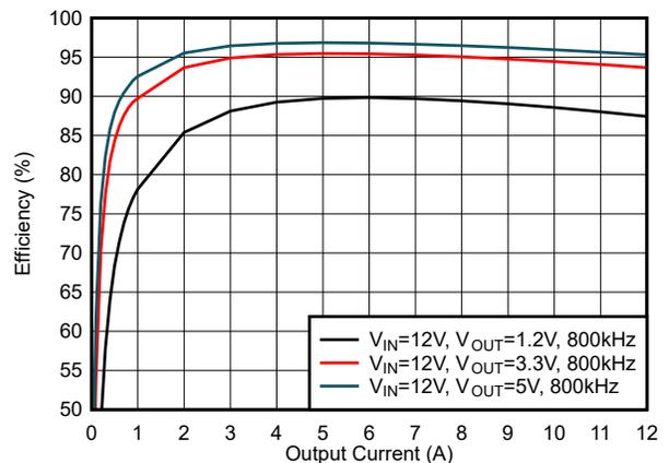
図 5-18. 効率 : FCCM モード、 $f_{sw} = 800\text{kHz}$
