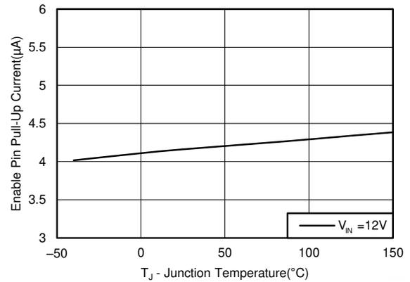
図 5-6. イネーブルプルアップ電流、V<sub>EN</sub> = 1.3V
