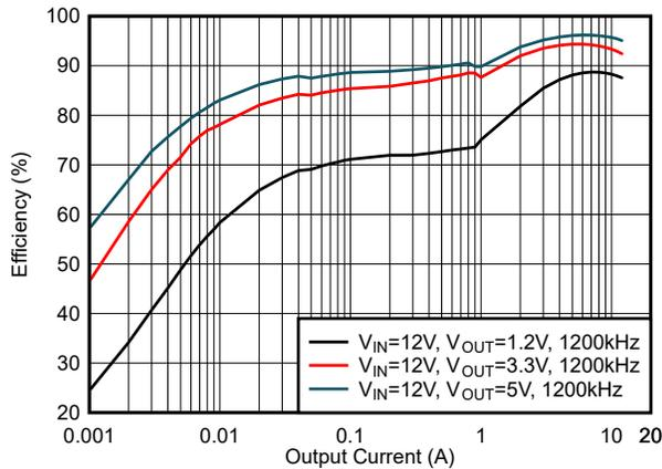
図 5-19. 効率 : DCM モード、 $f_{sw} = 1200\text{kHz}$
