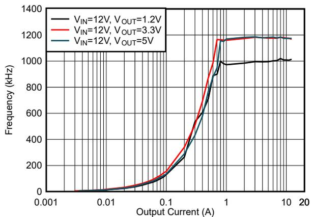
図 5-34.  $F_{SW}$  負荷レギュレーション : モード = DCM、 $F_{SW}$  = 1200kHz
