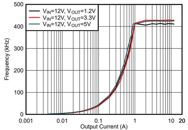
図 5-32.  $F_{SW}$  負荷レギュレーション : モード = DCM、 $F_{SW}$  = 400kHz
