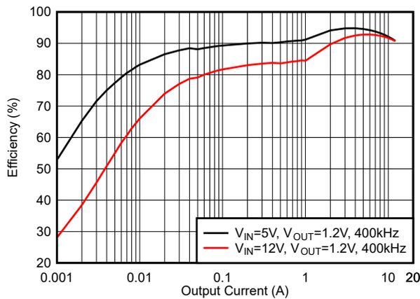
図 5-9. 効率 : DCM モード、 $f_{sw} = 400kHz$
