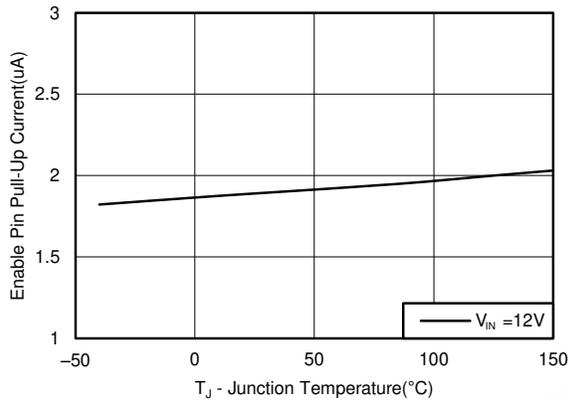
図 5-5. イネーブルプルアップ電流、V<sub>EN</sub> = 1.0V
