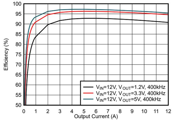
図 5-16. 効率 : FCCM モード、 $f_{sw} = 400\text{kHz}$
