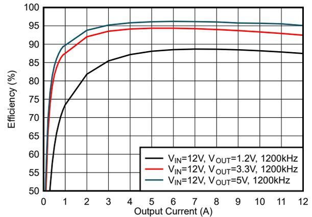
図 5-20. 効率 : FCCM モード、 $f_{sw} = 1200\text{kHz}$
