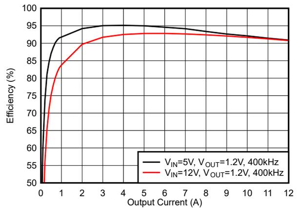
図 5-10. 効率 : FCCM モード、 $f_{sw} = 400kHz$
