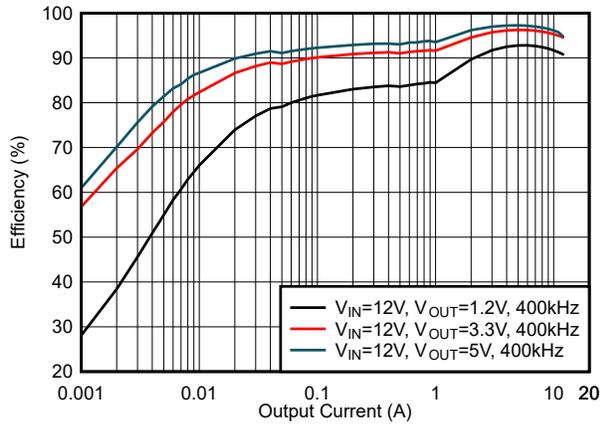
図 5-15. 効率 : DCM モード、 $f_{sw} = 400\text{kHz}$
