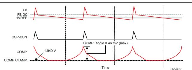
図 6-5. 自動スキップモードの過渡応答
