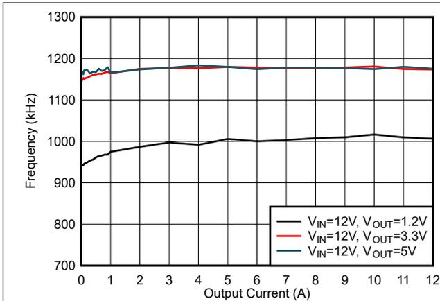
図 5-31.  $F_{SW}$  負荷レギュレーション : モード = FCCM、 $F_{SW}$  = 1200kHz
