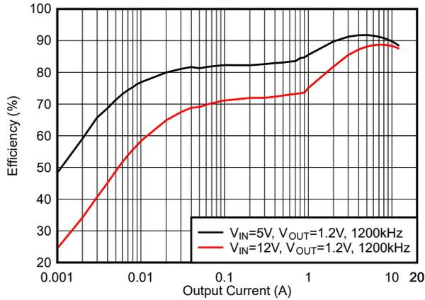
図 5-13. 効率 : DCM モード、 $f_{sw} = 1200\text{kHz}$
