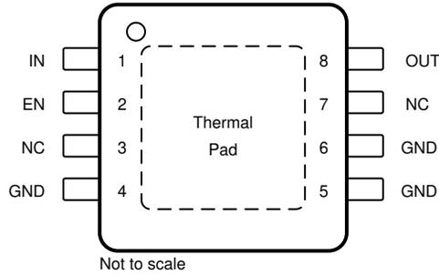
図 4-1. DGN パッケージ、8 ピン HVSSOP (上面図)
