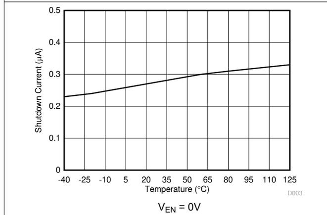
図 5-3. シャットダウン電流と周囲温度との関係
