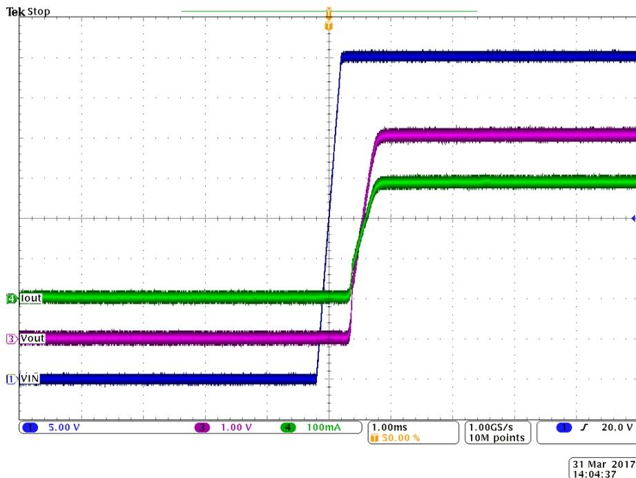
図 7-2. TPS7B82-Q1 のパワーアップ波形 (5V)
