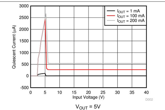
図 5-2. 静止電流と入力電圧との関係
