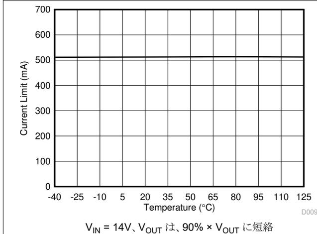
図 5-9. 出力電流制限と周囲温度との関係
