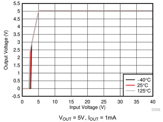
図 5-8. 出力電圧と入力電圧との関係
