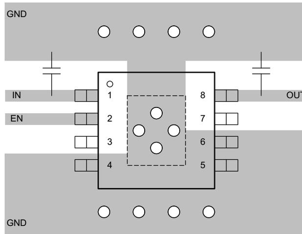
図 7-3. TPS7B82-Q1 のレイアウト図例
