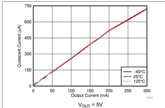
図 5-1. 静止電流と出力電流との関係
