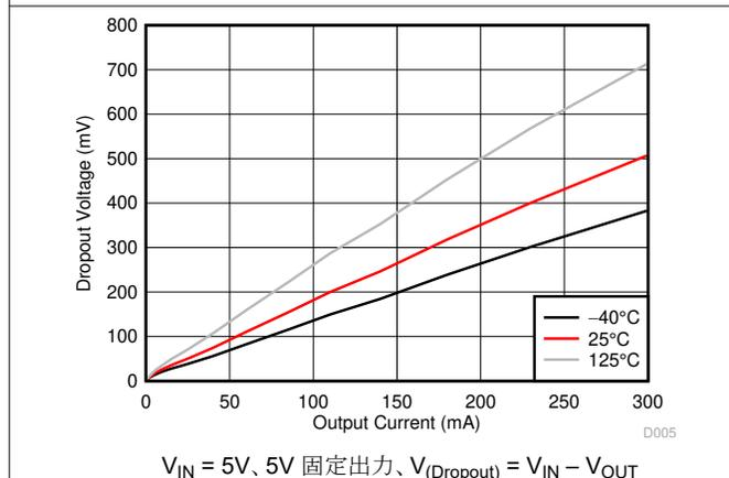
$V_{IN} = 5V$ 、 $5V$  固定出力、 $V_{(Dropout)} = V_{IN} - V_{OUT}$
