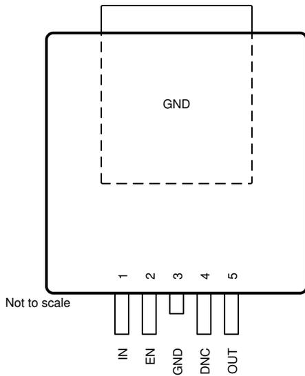
図 4-3. KVU パッケージ、5 ピン TO-252 (上面図)
