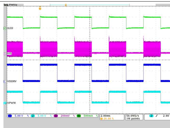
Ch1: DDRV電圧、Ch2: PWM入力、 Ch3: スイッチ・センス電流抵抗電圧、 Ch4: LED電流、時間: 2ms/div
